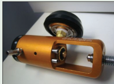
Illustration 2 : Régulateur du réservoir à oxygène; à remarquer la présence de la rondelle d'étanchéité.
