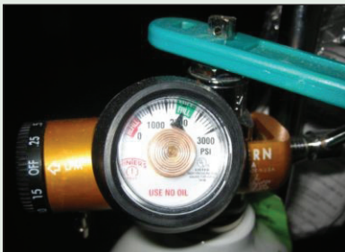
Illustration 1 : Manomètre d'un réservoir à oxygène indiquant une pression de 2000 psi.
