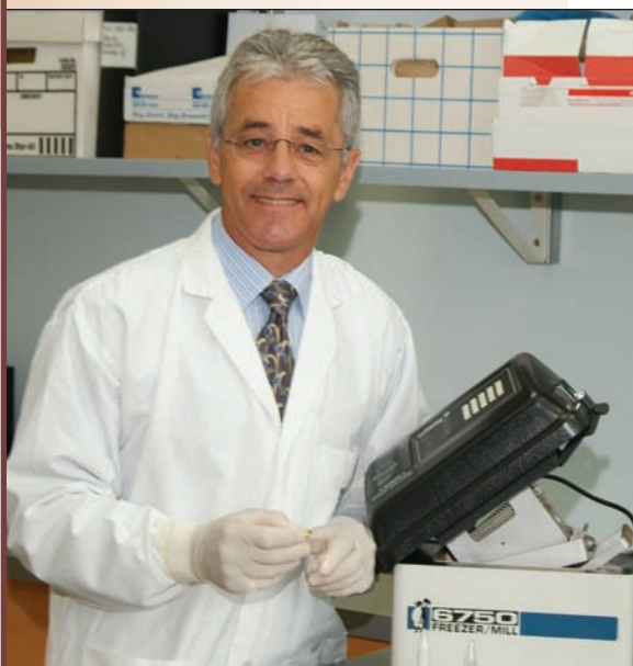
Le Dr Sweet au laboratoire du BOLD. Le broyeur à froid sert à préparer cryogéniquement un échantillon de dent pour en extraire l'ADN. Photo : Dr Leon Woolf.
