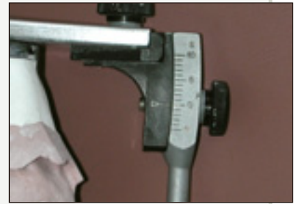
Illustration 6 : La tige de l'articulateur est réglée à «0». Cette dimension verticale doit rester inchangée durant la fabrication de l'ODNAS.
