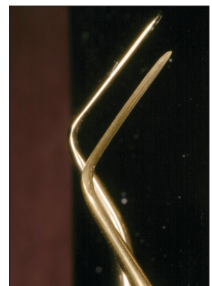
Illustration 14 : Instrument très mince (Interproximal Carver IPC, N-5110P, Bisco Dental Products) utilisé pour pratiquer les rainures (en haut), par comparaison à un instrument d'épaisseur normale.
